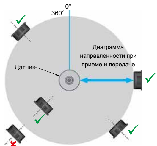
Вид сверху, иллюстрирующий диаграмму направленности, охватывающую 360°, и примеры возможного расположения приемников
