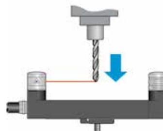
Бесконтактная наладка инструмента с использованием лазерной системы
