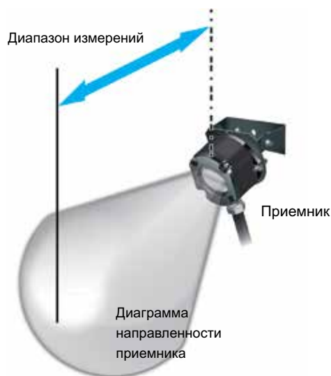
Оптические приемники компании Renishaw имеют диаграммы направленности, напоминающие по виду воздушный шарик неправильной формы.
